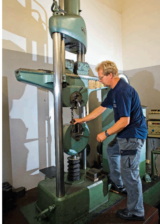
Auf der Reißprüfmaschine des MAN-Prüflabors in Hamburg wurden die Kettenmuster eingespannt und bis zum Bruch belastet.
